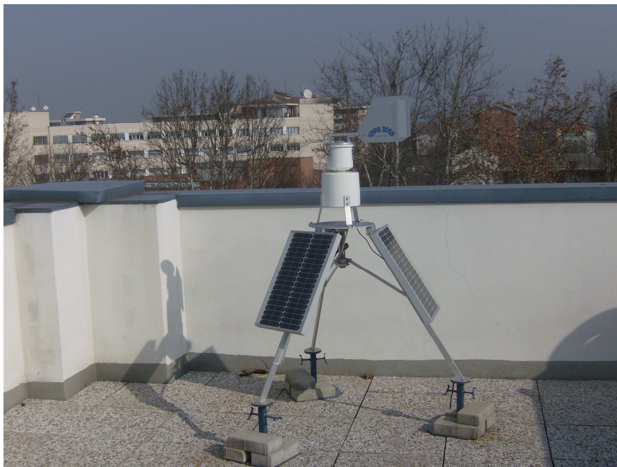
Fig.3 - Campionatore VPPS2010 del Dipartimento di Alessandria.
