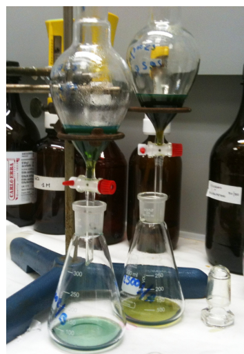
Figure 11 e 12 processo di estrazione L-L
