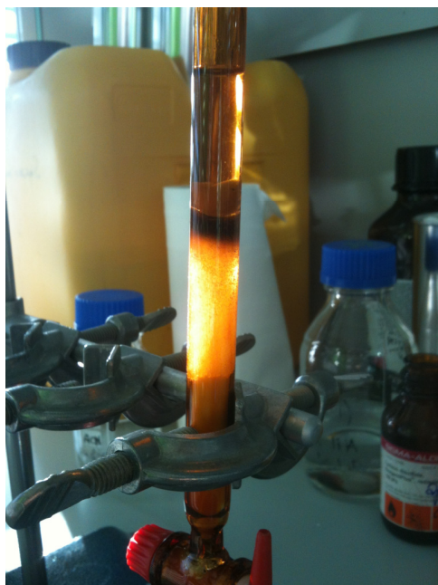
Figure 3 e 4: Colonnine in vetro scuro per la purificazione dei campioni.
