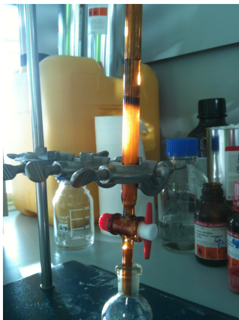
Figure 3 e 4: Colonnine in vetro scuro per la purificazione dei campioni.
