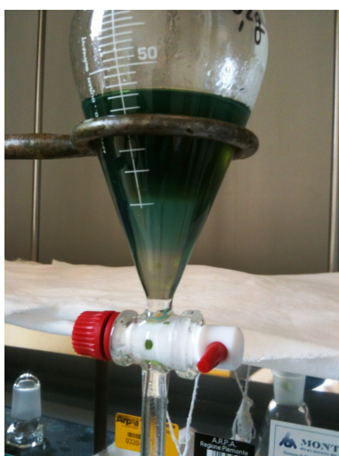
Figure 11 e 12 processo di estrazione L-L
