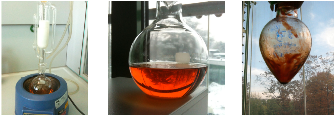
Figure 6, 7 e 8: Estrazione in Soxhlet, estratto in solvente e dopo passaggio in rotavapor
