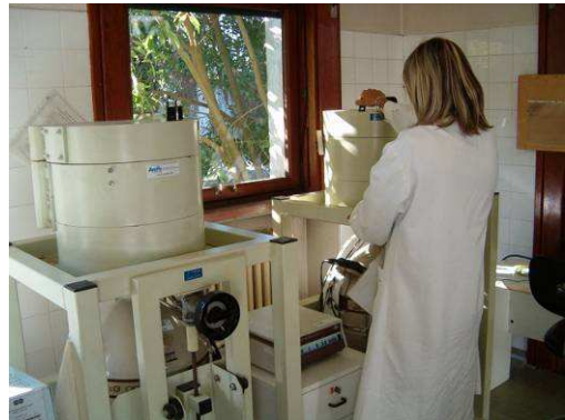
Catene spettrometriche gamma con rivelatori al Germanio
