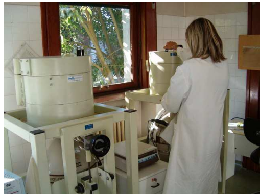
Catene spettrometriche gamma con rivelatori al Germanio
