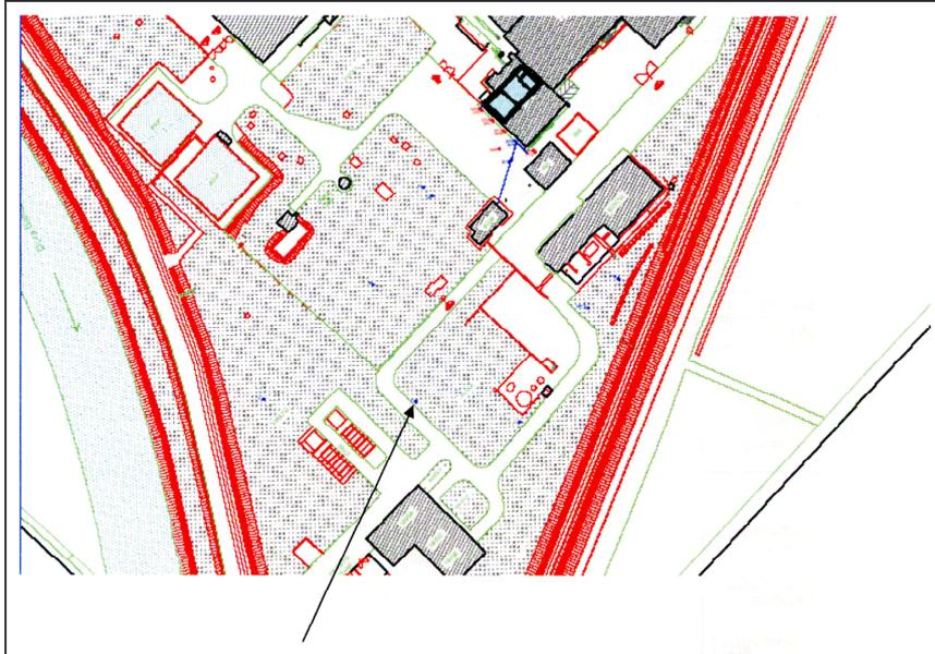
**Figura 5.3** Posizione dei punti di campionamento dell'acqua di falda superficiale; il punto evidenziato dalla freccia è il pozzo SPQ (in rosso il perimetro esterno dell'impianto).
