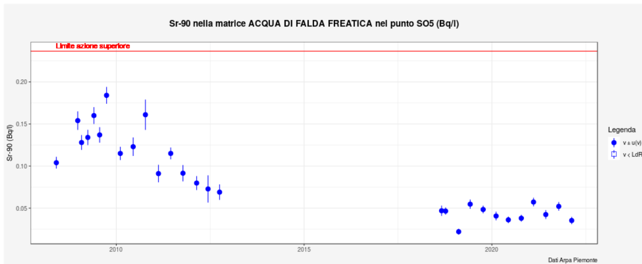
Figura 5.10. Andamento della concentrazione di Sr-90 nell'acqua di falda superficiale campionata nel punto SO5 (Bq/l) – La linea rossa rappresenta il limite di azione pertinente.
