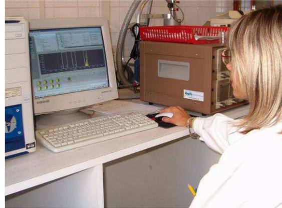
Catene spettrometriche alfa con rivelatori al silicio
