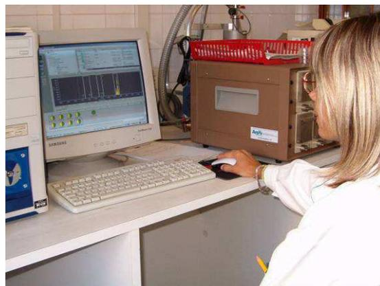
Catene spettrometriche alfa con rivelatori al silicio
