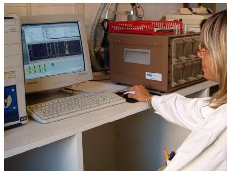
Catena spettrometrica alfa con rivelatori al Silicio
