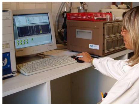
Catena spettrometrica alfa con rivelatori al Silicio
