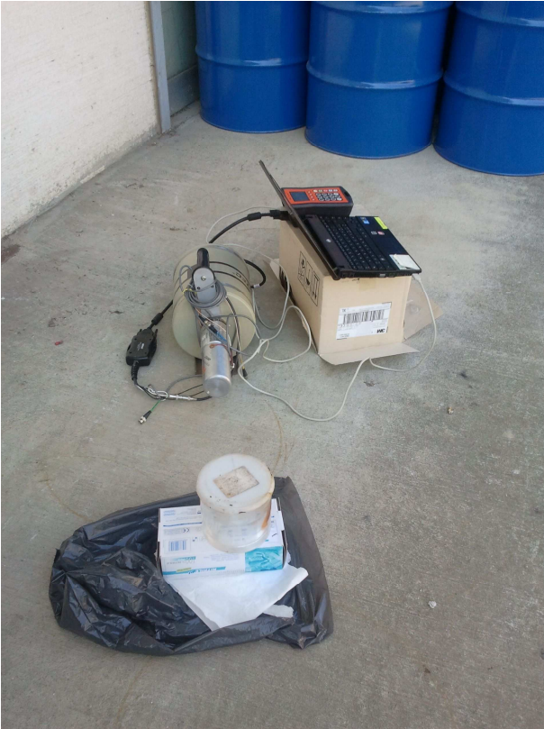
Foto. n.8 spettrometria gamma su una QCY
