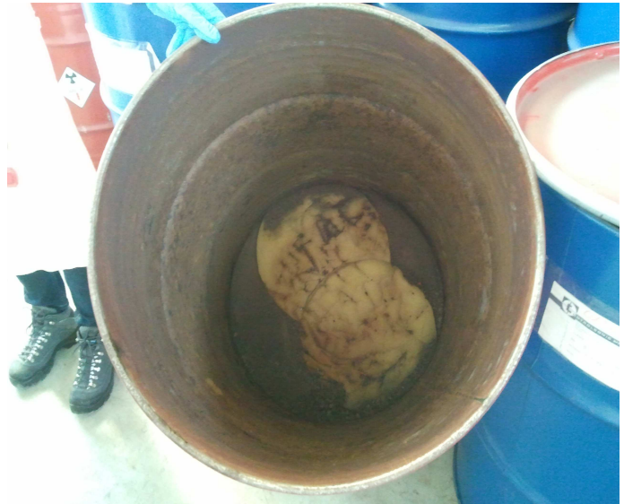
Foto n.3 esempio di fusto arrugginito e ammalorato
