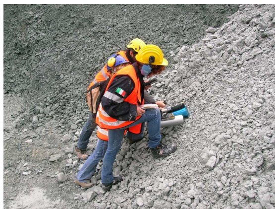
Figura 54: misure in doppio di rateo di dose gamma sui cumuli di smarino
