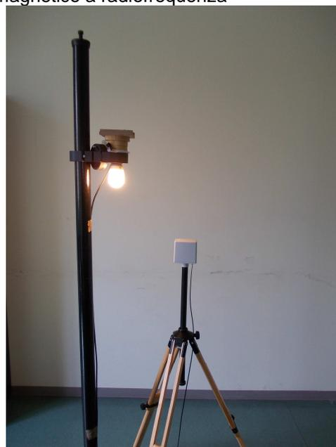
Sono state inoltre osservate eventuali dipendenze dell'intensità di campo e della frequenza di emissione dai parametri della lampada: potenza, tipologia e temperatura di colore. Per questo motivo, sono state scelte le 7 lampade con maggiore variabilità di questi parametri.
