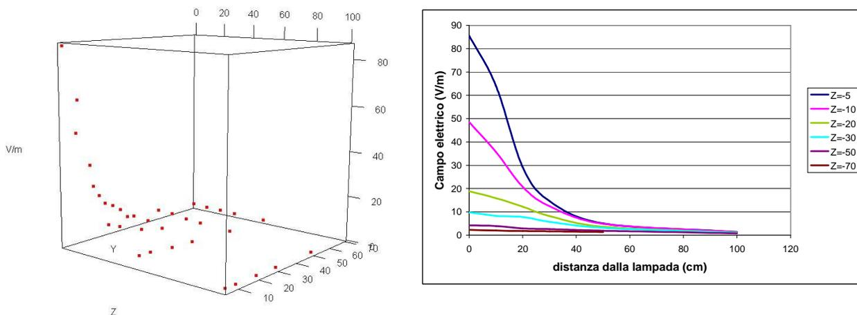
A sinistra, livelli di campo elettrico in funzione di Z ed Y. A destra, andamento del campo in funzione di Y per diversi valori di Z.
