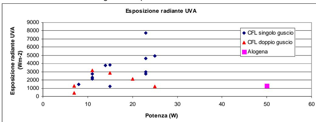
Sono riportati i livelli di esposizione radiante in funzione della potenza valutati per le lampade fluorescenti confrontati con gli analoghi di una lampada alogena
