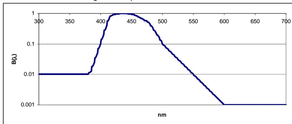
È riportato lo spettro d'azione per la luce blu. La massima efficacia della radiazione ottica per questo effetto è nell'intervallo spettrale compreso tra 420 e 460 nm,
