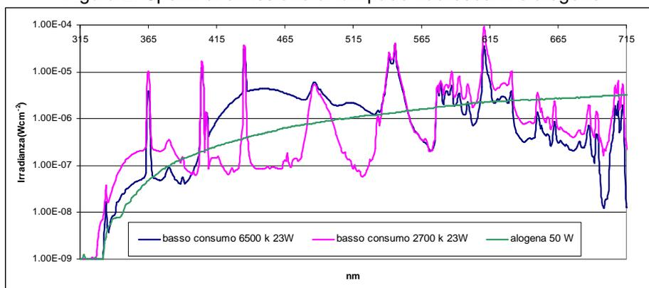
Sono riportati gli spettri d'emissione di una lampada fluorescente a luce calda (temperatura di colore 2700k) e una a luce fredda (temperatura di colore 6500k) confrontati con quello di una lampada alogena. Nelle lampade fluorescenti si distinguono chiaramente i picchi di emissione del mercurio nell'UV.
