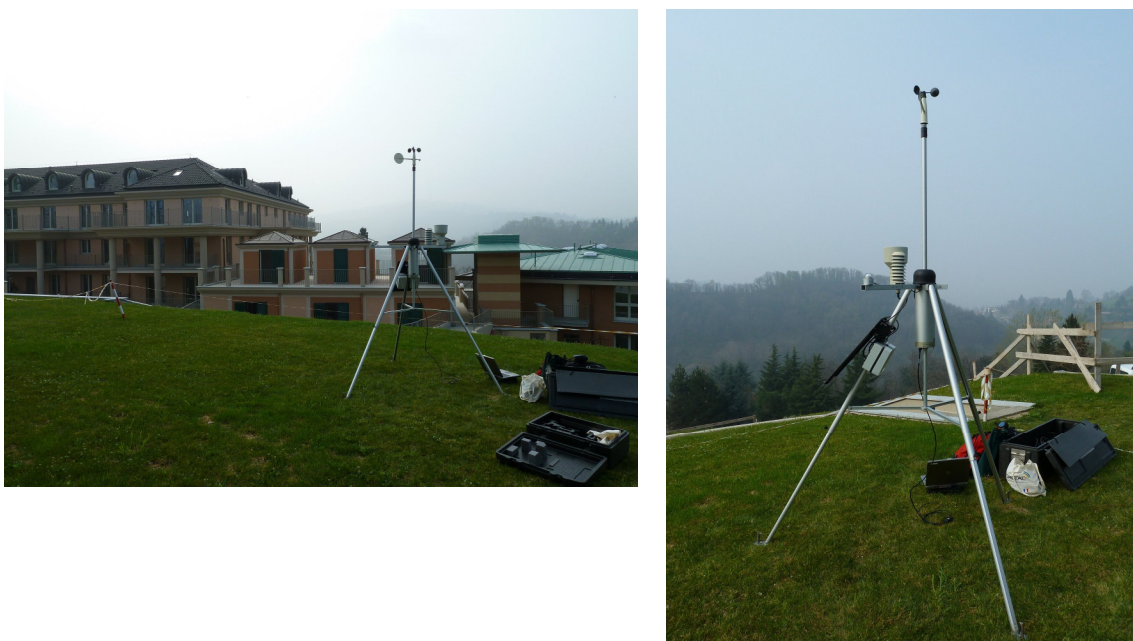
Figura 12 – La stazione portatile MAWS installata presso le Ville Ottolenghi
