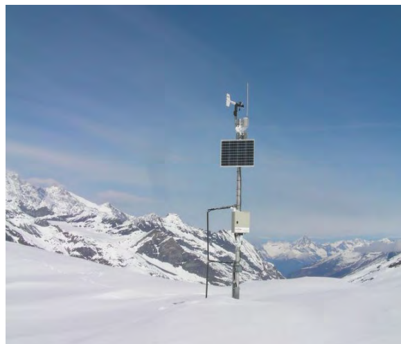
Figura 3.4.: Stazione nivometeorologica di Passo Moro, sita nel comune di Macugnaga (VB) - 2820 m di quota. In particolare si vede lo strumento snow-drift che rileva il trasporto della neve ad opera del vento.
