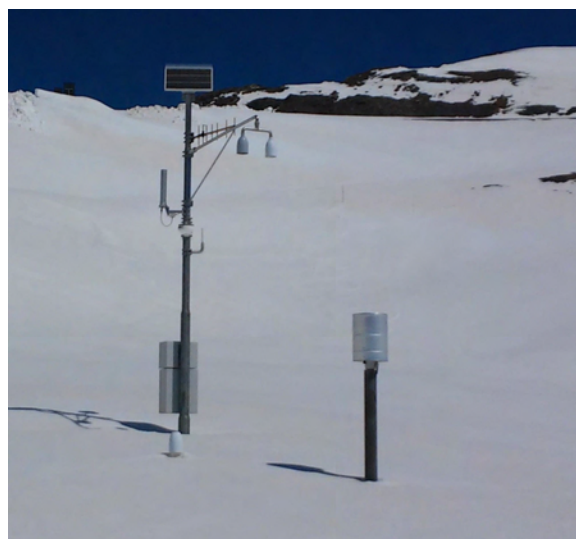
Figura 3.9: stazione nivometeorologica automatica di Colle dell'Agnello, comune di Pontechianale (CN) - 2685 m di quota, maggio 2016.
