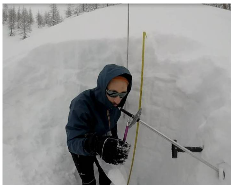
Figura 3.15: Esecuzione di un rilievo itinerante: pesata di una carota campione di uno degli strati identificati nel manto nevoso per determinarne la massa volumica
