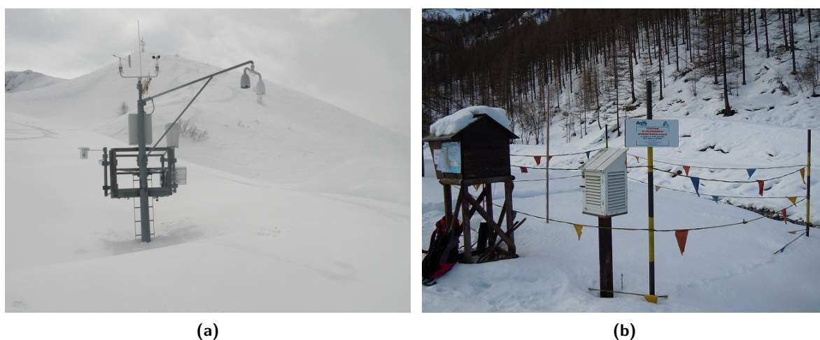
Figura 3.16: 3.16a Esempio di stazione nivometeorologica automatica (Stazione di Limone Pancani - CN); 3.16b esempio di stazione manuale (Stazione di Traverses, Pragelato - TO)
