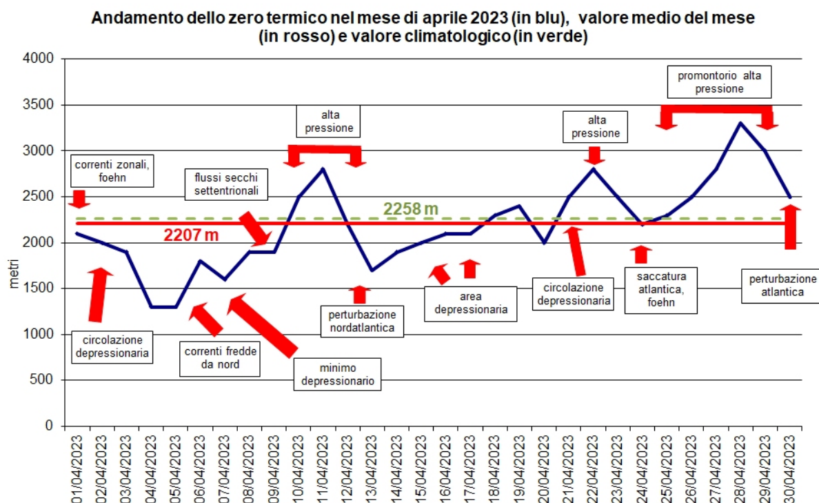
Figura 2.30: Andamento dello zero termico nel mese di aprile 2023 (in blu), valore medio del mese (in rosso) e valore climatologico (linea tratteggiata verde). Sono indicate le principali configurazioni meteorologiche responsabili delle variazioni dello zero termico
