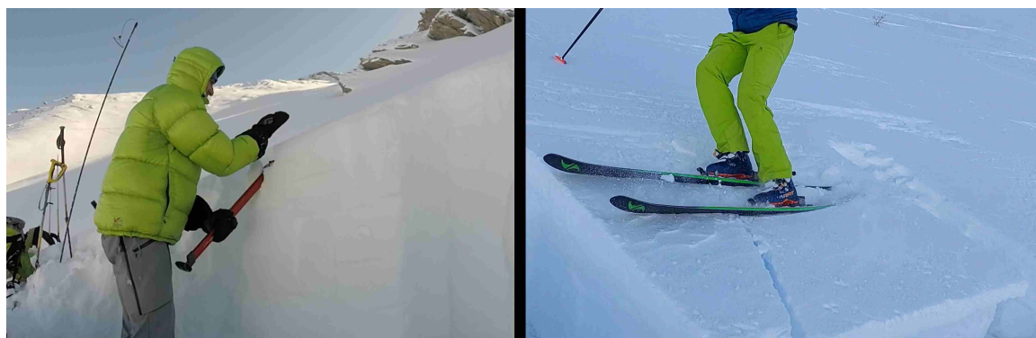
Figura 3.18: Test di stabilità del manto nevoso. A sinistra l'ECT (Extended Column Test ovvero test della colonna estesa), a destra l'RB (Rutschblock ovvero test del blocco di slittamento).
