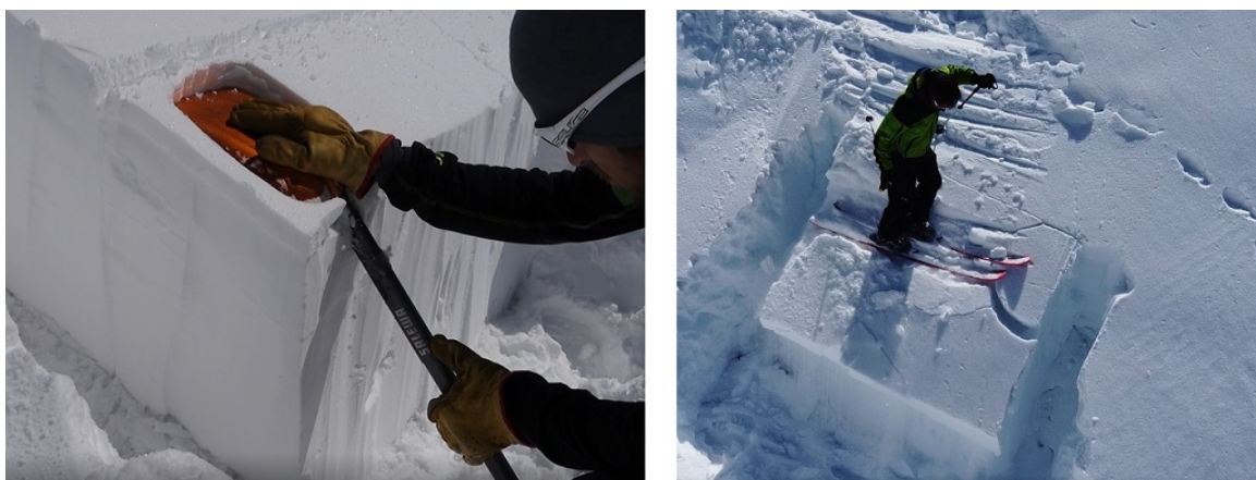
Figura 3.15: Test di stabilità del manto nevoso. A sinistra l'ECT (Extended Column Test ovvero test della colonna estesa), a destra l'RB (Rutschblock ovvero test del blocco di slittamento ripreso dal drone).
