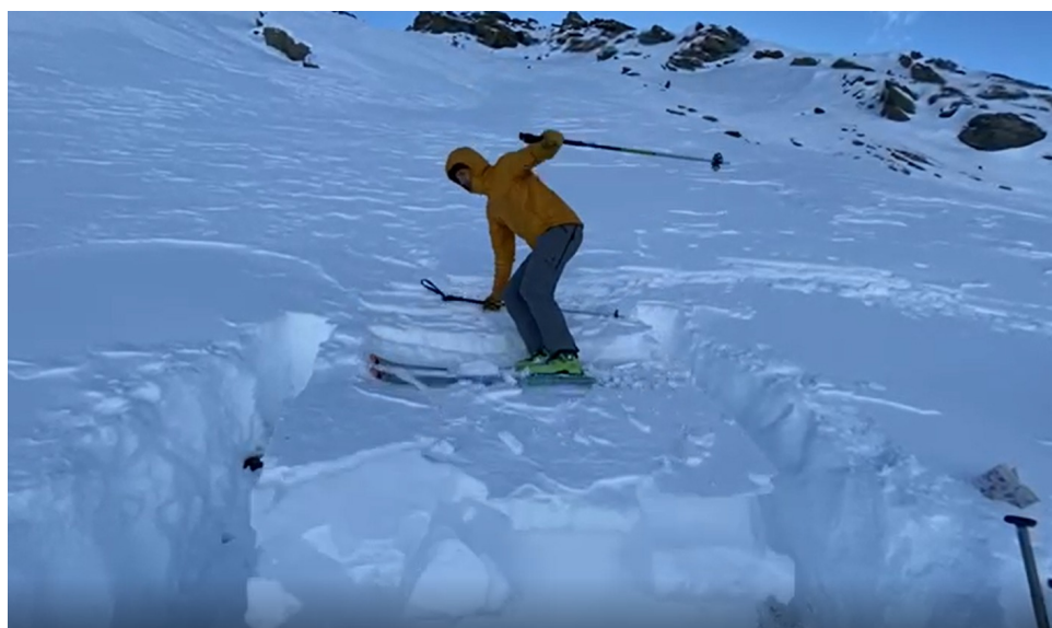
Figura 4.13: Sollecitazione con forte sovraccarico degli strati superficiali mediante l'esecuzione del Rutchblock.
