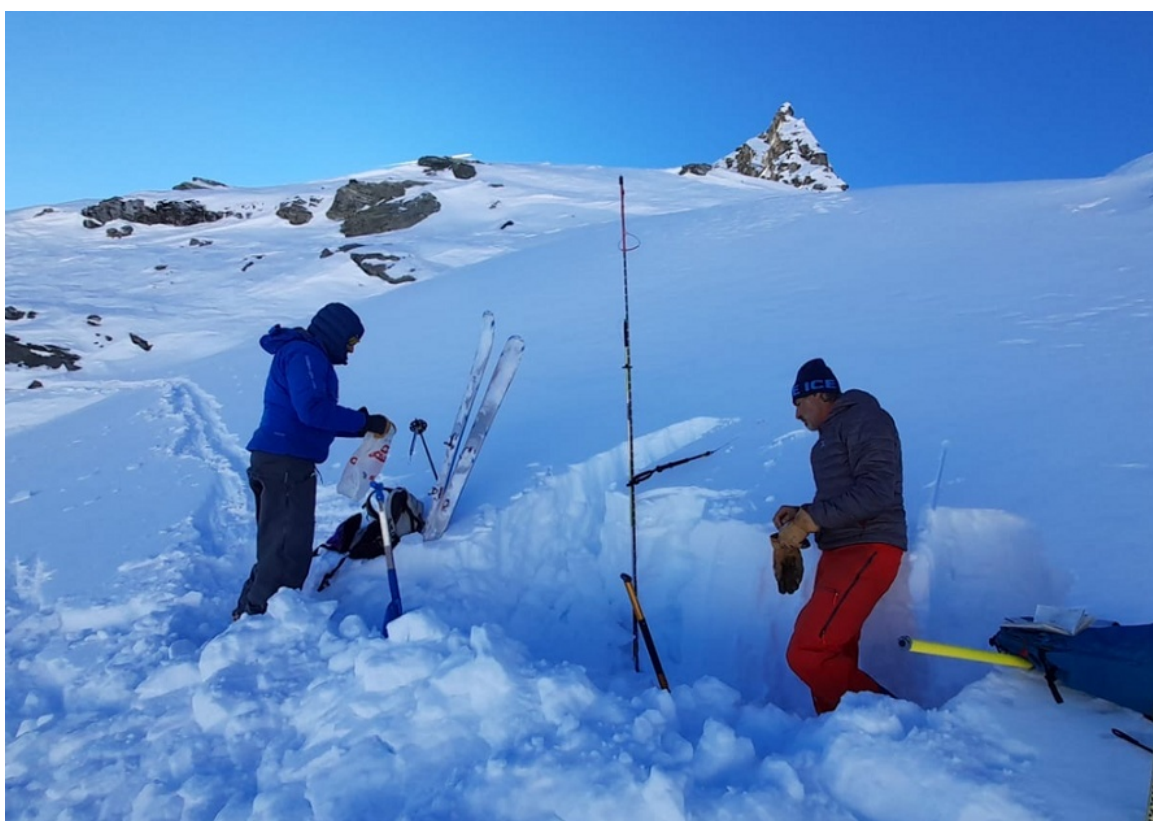
Figura 3.14: Fase di apertura del profilo nivologico nei pressi del Passo Zube, Alagna Valsesia (VC).
