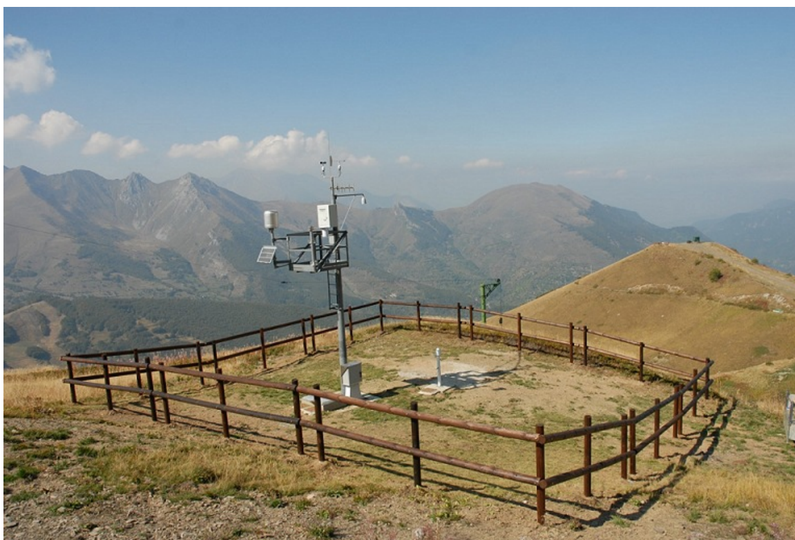
Figura 3.11: Un esempio di stazione nivometeorologica automatica. Stazione di Limone Pancani (CN).
