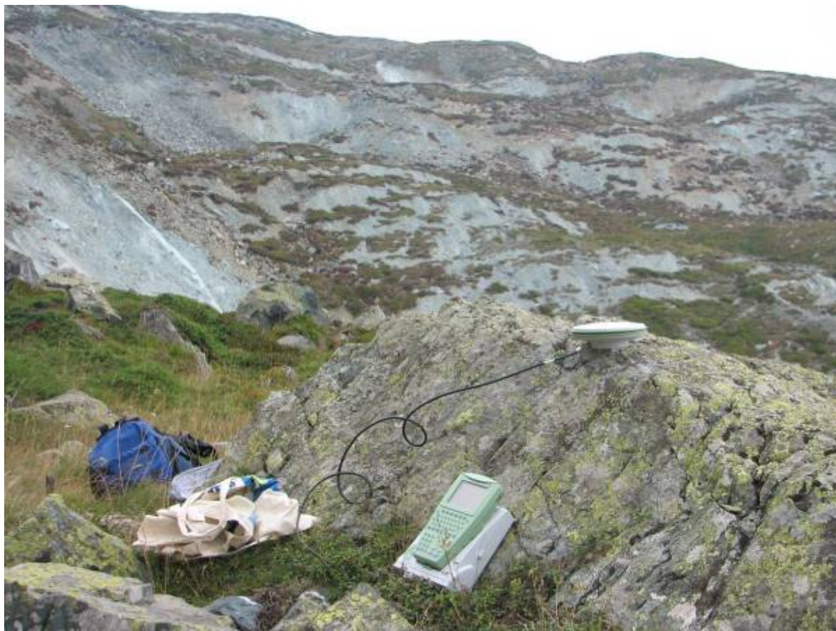
Figura 3.6 – Ricevitore GPS in fase di acquisizione sul caposaldo G4SMPA7
