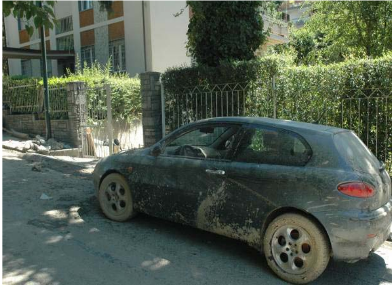
Figura 2. Automobile danneggiata; sulla fiancata è visibile il livello raggiunto dall'acqua (70 cm circa).
