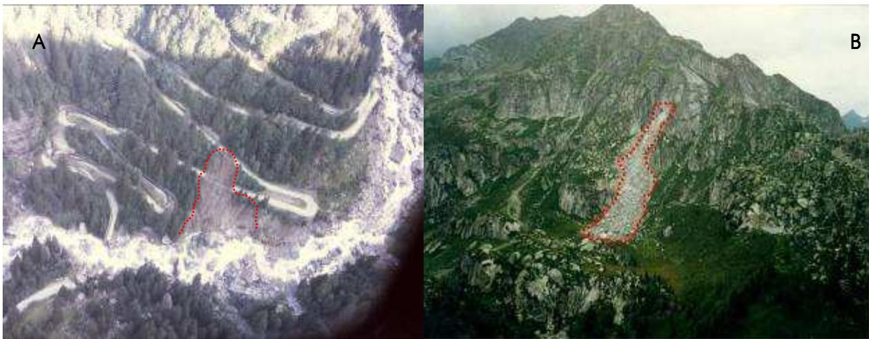
Figura 13 - A. Loc. Casse: la S.S.659 che collega Formazza con il resto della valle viene interrotta per asportazione del ponte e da alcune frane innescatesi per erosione al piede operata dal fiume Toce.
