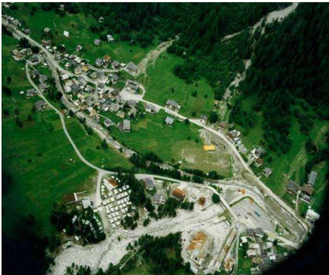
Figura 15 - Parte terminale del torrente Vannino: in sponda sinistra il campeggio alluvionato e in destra edifici interessati dai massi trasportati dalla colata. (Archivio fotografico ARPA Piemonte)
