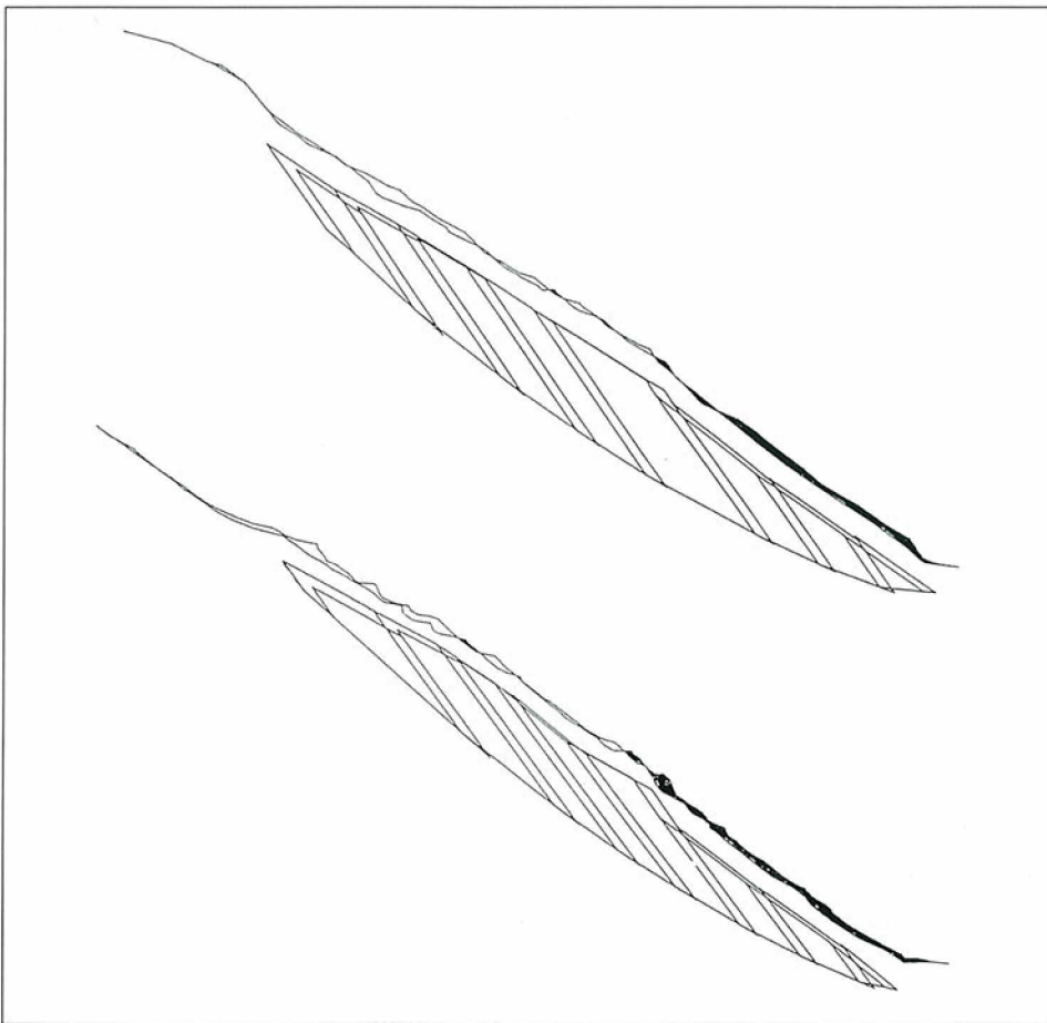
Fig. 24. Modèles cinématiques. Des modèles en deux dimensions de déplacements de blocs rigides inclinés vers l'aval glissant sur une surface limite choisie conduisent à des mouvements superficiels compatibles à la fois avec les déformations réelles et avec l'orientation des vecteurs déplacements.
