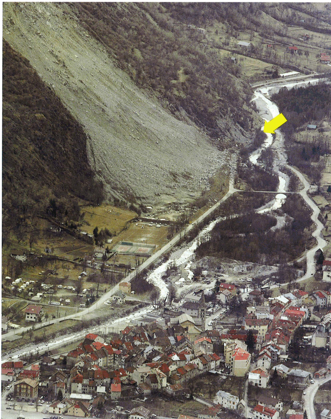
Fig. 29. Le village et le pied du glissement en mars 1992. La photographie est prise de l'amont vers l'aval, dans l'axe de l'ancienne route détruite en rive gauche et elle montre la proximité entre le village et le glissement. L'avancée du versant repousse la rivière vers la rive droite où un route provisoire a également été détruite.
