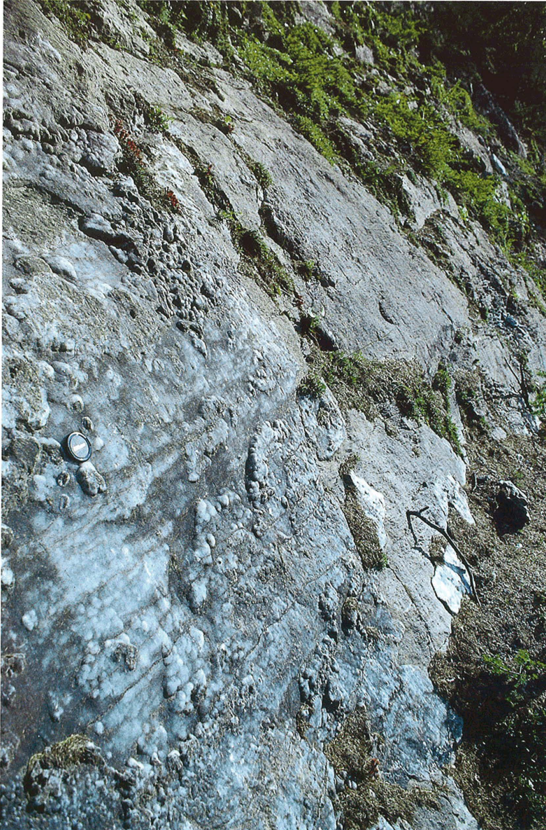
Fig. 9 - Frana del Cassas: immagine particolare di una superficie di discontinuità esposta in zona di scarpata sommitale. Sono evidenti depositi concrezionali calcitici sulla superficie della roccia calcescistosa.
