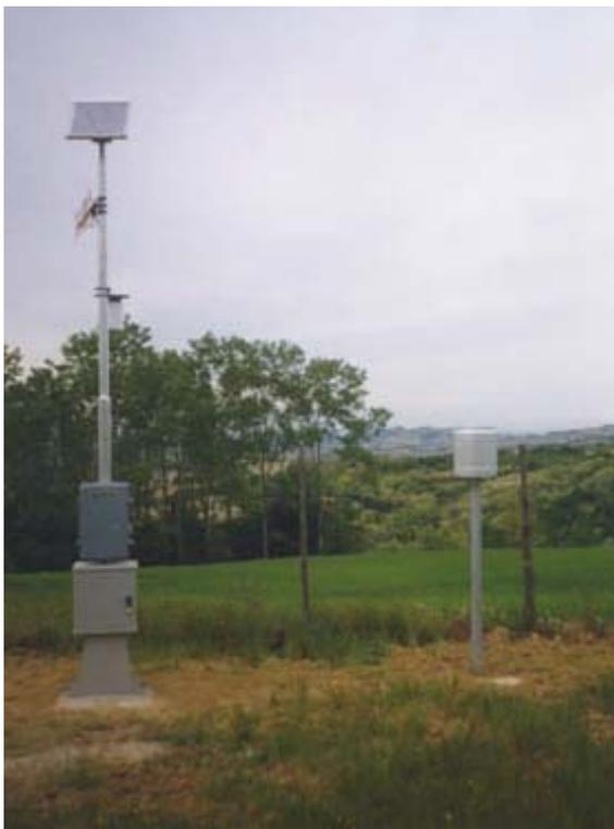
Figura I-5. Stazione termopluviometrica in teletrasmissione della Regione Piemonte
