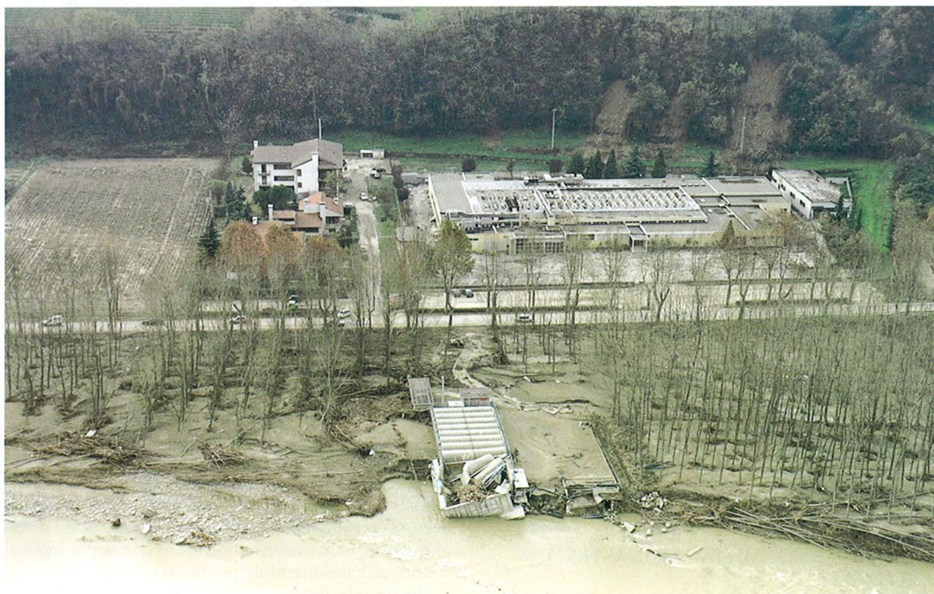
**Fig. 68.** Fiume Bormida di Millesimo. La piena fluviale ha provocato la distruzione dell'impianto di depurazione posto poco a valle dell'abitato di Cortemilia. Le acque di allagamento hanno raggiunto, su altezze di qualche decimetro, l'edificio artigianale posto sullo sfondo.
