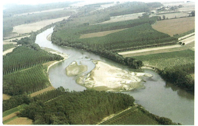
Fig. 49. Bassignana, località Ponte della Vittoria. Novembre 1994: azione erosiva del Fiume Tanaro con formazione di ampie lune.
