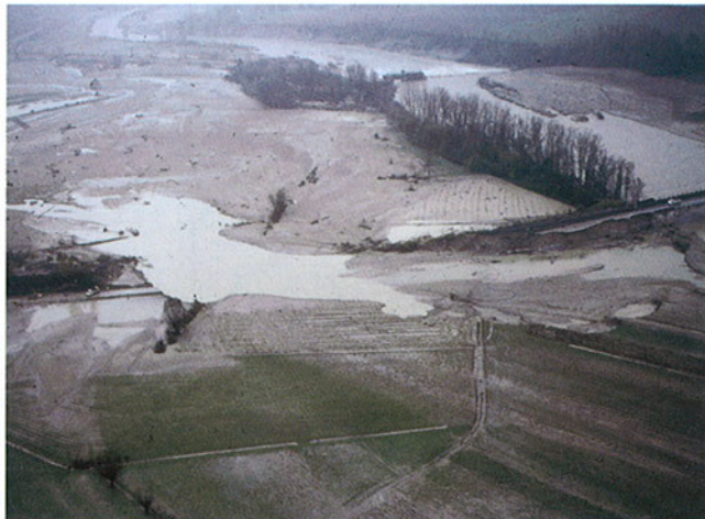
Fig. 52. Fiume Tanaro: strada provinciale n. 12 "Fondovalle", tratto Farigliano-Cherasco. Esempio di asportazione completa, per erosione fluviale, di due tratti di rilevato contigui a ponti.
