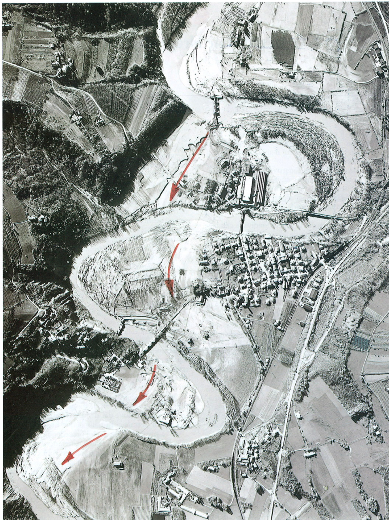
Fig. 1. Fiume Tanaro. Area di Clavesana. La valle fluviale in una immagine ripresa una settimana dopo l'evento alluvionale. Dalle evidenze morfologiche è chiaramente desumibile come parte preponderante della massa d'acqua sia transitata al di fuori del canale di deflusso in forma di "virtuali" tagli di meandro che, nella prima ansa in alto, hanno provocato una evidente e profonda forma erosiva sulla superficie del terrazzo alluvionale. Scala approssimata 1:10.000, Nord in basso a destra della foto. (Conc. SMA n. 1-431 del 9-7-1998).
