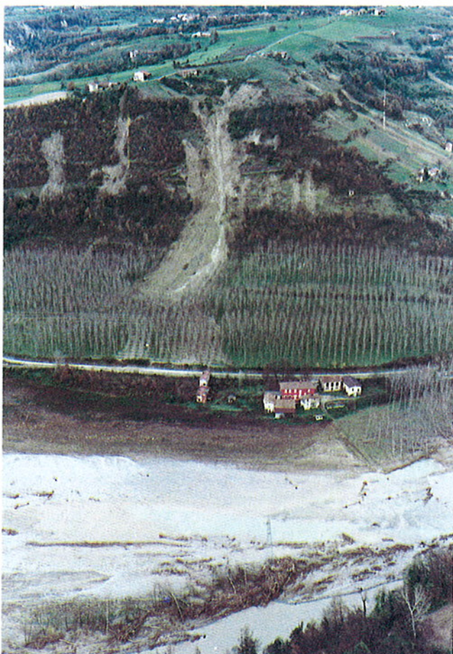
Fig. 6. Fiume Tanaro. L'immagine riprende un processo di mobilizzazione e colamento della copertura alterata su un versante, in sponda destra del corso d'acqua, nella zona meridionale delle Langhe. In basso è altresì visibile la vasta area occupata dalle acque della piena fluviale.
