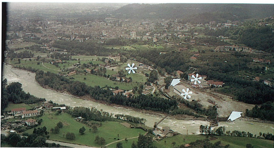
Foto 41 - Cuornè (TO). Riattivazione di un ramo destro del T. Orco utilizzato come canale derivatore. Cuornè è sullo sfondo. La freccia a destra indica il punto della rotta principale, pochi metri a monte dell'opera di presa. Gli asterischi indicano le infrastrutture danneggiate. Al centro della foto in basso: l'erosione sulla sponda sinistra ha asportato la spalla della passerella e minacciato un'abitazione rurale.
