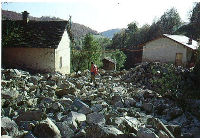
Fig. 51. Danni ai centri abitati: settore di conoide riattivato per fenomeni di alluvionamenti con deposizione di materiali grossolani.
