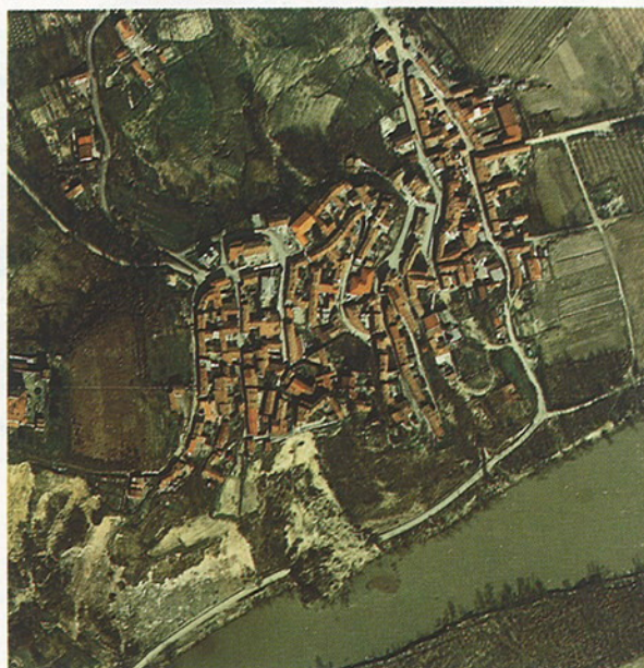
Fig. 5 - Ripresa aerea dell'abitato effettuata pochi giorni dopo l'evento del 9 marzo 1978. Ben visibile in basso la frana complessa di scorrimento rotazionale passante a colamento che sbarrò parzialmente l'alveo del Tanaro. In alto si individua il vasto scorrimento traslativo di regione Foriara. (Conc. S.M.A. N. 144 del 17 dicembre 1993).
