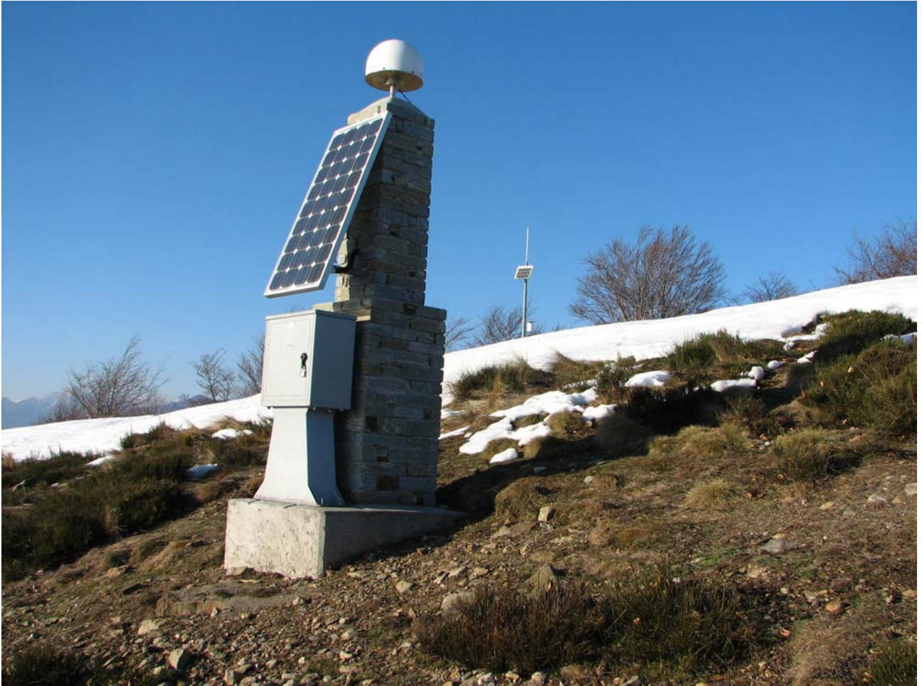
La stazione GPS permanente e la stazione meteorologica presso il M.te Carza
