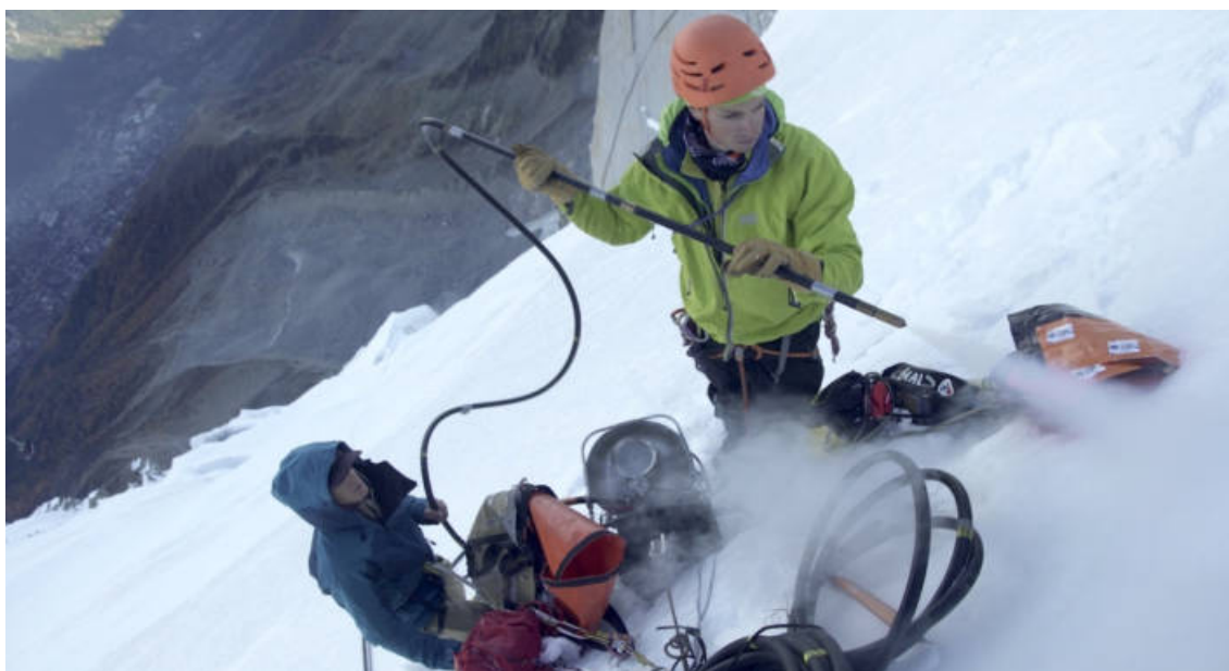
Figura 8 – Installazione di una catena di sensori di temperatura in uno dei ghiacciai sospesi dell'Aiguille du Midi (Chamonix, Francia). Un sensore di temperatura inserito nella roccia completa il dispositivo.
