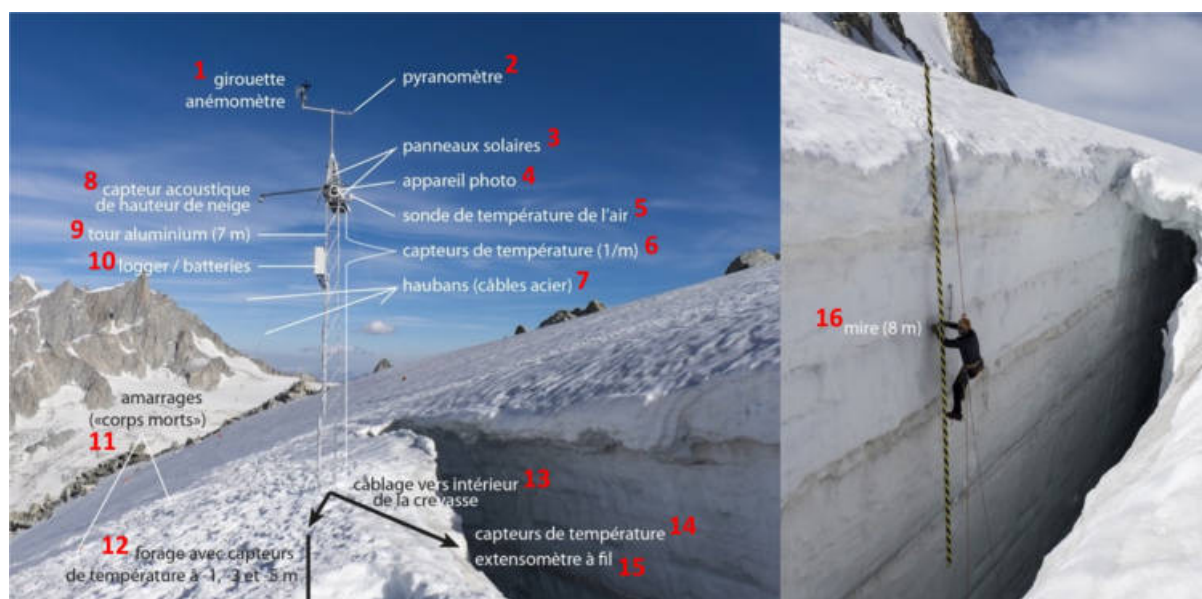
Figura 26 – Dettaglio della strumentazione al Col du Midi (Chamonix, Francia). 1 - anemometro a banderuola o anemogoniometro; 2 - piranometro; 3 - pannelli solari; 4 - macchina fotografica; 5 - sensore di temperatura dell'aria; 6 - sensori di temperatura (1 ogni metro di altezza); 7 - tiranti (cavi d'acciaio); 8 - nivometro ad ultrasuoni; 9 - traliccio in alluminio; 10 - acquisitore dati (datalogger) e batterie; 11 - ancoraggi ("corpi morti"); 12 - perforazione strumentata con sensori di temperatura posti a 1, 3 e 5 m di profondità; 13 - cavidotto per strumenti posti all'interno del crepaccio; 14 - sensori di temperatura (interni al crepaccio); 15 - estensimetro a filo (interno al crepaccio); 16 - elemento di riferimento lungo 8 m per la ripresa fotografica.
