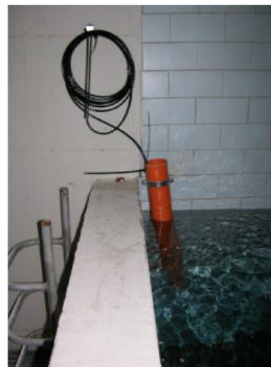
Fig.1 - Opera di captazione / Ouvrage de captage. - Installazione sonda multiparametrica / Installation de sonde multiparamétrique.
