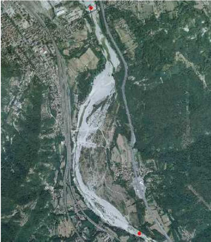
Il secondo tratto del CI 10SS3N711PI ha subito, per buona parte, alterazioni dell'assetto morfologico tali da causare la perdita (F7 in C) delle forme e dei processi tipici della configurazione *wandering* che lo caratterizzava nel 1954. A monte del ponte per Vocemola l'alveo dello Scrivia tende a restringersi e a incidere in corrispondenza della curva in sponda sinistra, dove pare trasformarsi in unicursale con forte alterazione della variabilità della sezione (F9 in C).
