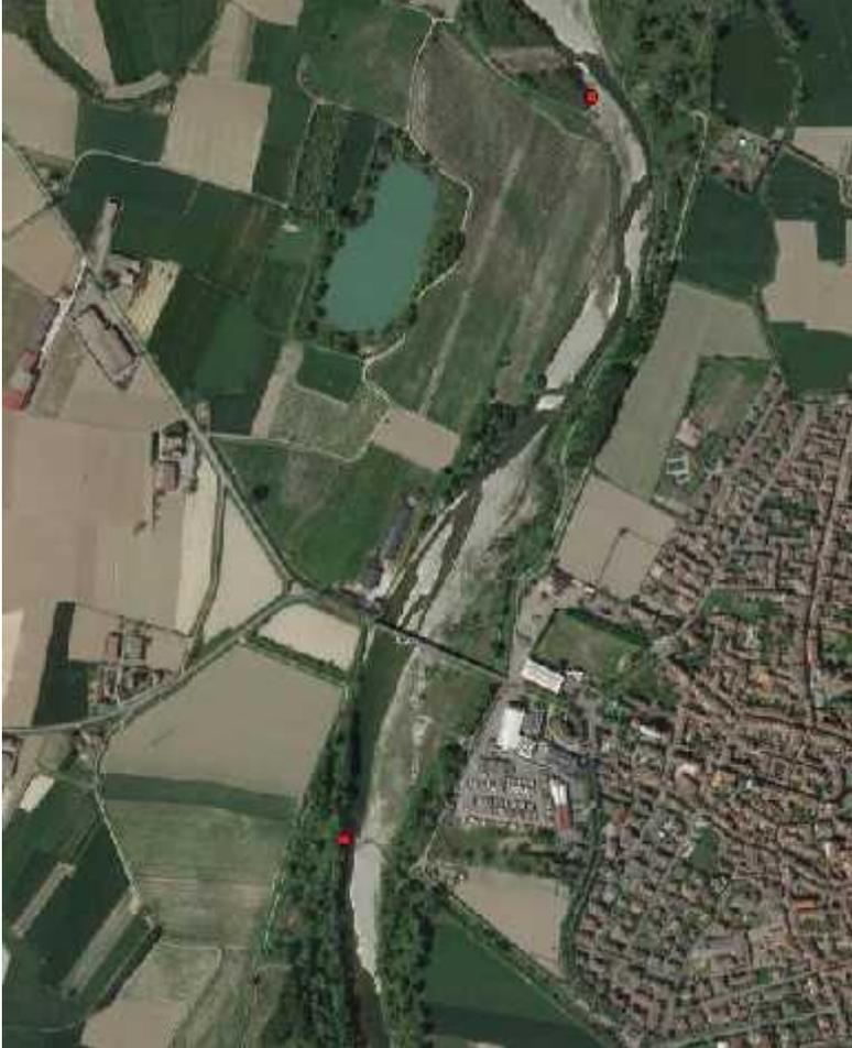
Il primo tratto si trova a ridosso dell'abitato di Castelnuovo Scrivia ed ha inizio alla confluenza del torrente Grue. La tipologia dell'alveo, sinuoso a barre alternate, è alterata dalla presenza del ponte che ha agito sulla morfologia trasformando per una lunghezza di 274 metri l'alveo in pluricursale.
