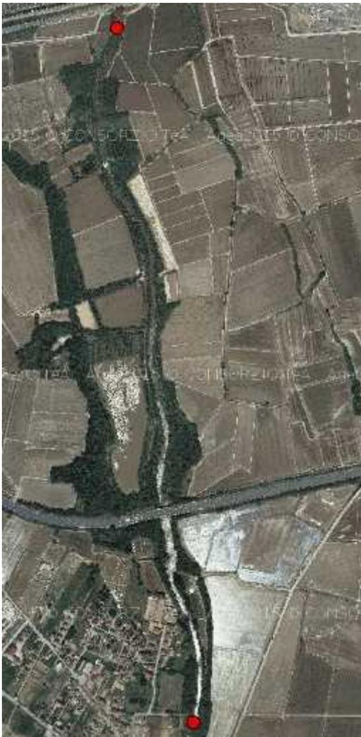
Il tratto presenta una soglia, l'attraversamento del canale Cavour che interferisce con il corridoio fluviale (A5 in B) e subito a valle una traversa di derivazione (A9 in B).
