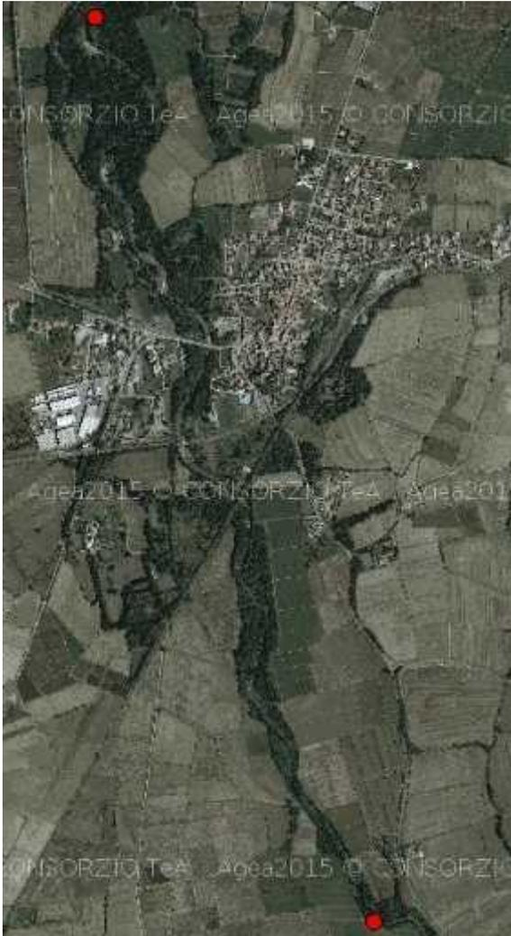
Il quarto tratto lambisce l'abitato di Rovasenda. Le maggiori criticità presenti nel tratto sono legate all'artificialità: la traversa di derivazione (VC00027) ad uso agricolo, posta a monte del ponte della SP3, altera la continuità longitudinale nel flusso di sedimenti (A4 in B e F1 in B); i vari attraversamenti stradali ferroviari interferiscono con il corridoio fluviale (A5 in B).
