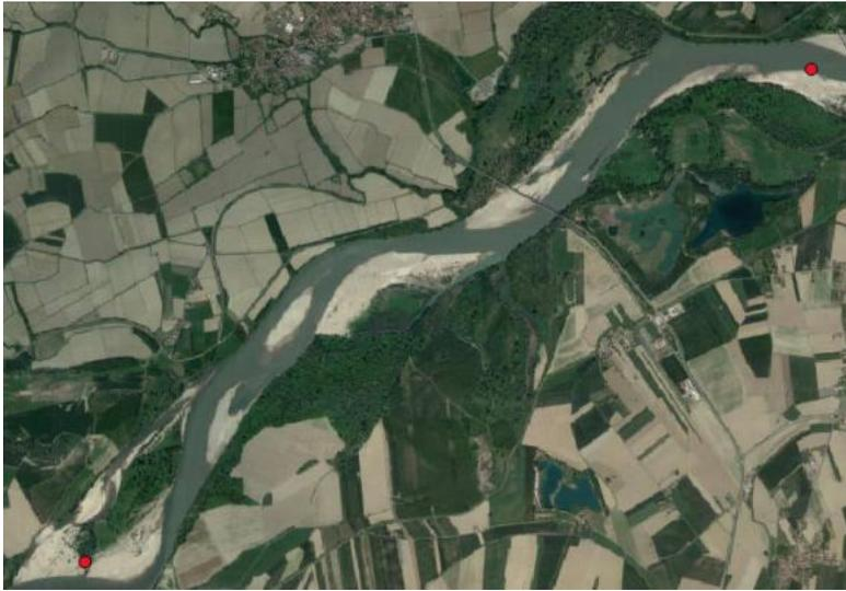
Il secondo tratto presenta tipologia sinuosa, difese per il 42% delle sponde e argini vicini per il 52%, A6 in classe C e A7 in classe B. La configurazione del corso d'acqua è mutata essendo stata meandriforme nel 1954, V1 classe B. Una cartografia IGM del 1884 mette in evidenza un alveo ancora differente dal '54 a testimoniare le evoluzioni degli alvei italiani nel tempo innescate da cause antropiche differenti dalla metà dell'800 agli anni '50, fino agli anni '90 e nell'ultimo trentennio.
