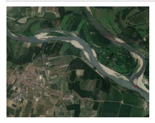
Il corso d'acqua nel tratto ha subito una trasformazione da alveo tipo anastomizzato a sinuoso con un restringimento del 64% e un approfondimento medio di circa 2 metri. Fino al 1954 l'alveo ha mantenuto la tipologia già presente nel 1800, a fine anni '60 la trasformazione in canale unicursale era già quasi completamente avvenuta. Le difese spondali rivestono il 40% delle sponde.
