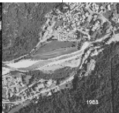
L'analisi aerotofogrammetrica multitemporale evidenzia l'importante erosione della sponda idr. sinistra e la variazione morfologica dell'alveo avvenuta in quella porzione di tratto.
