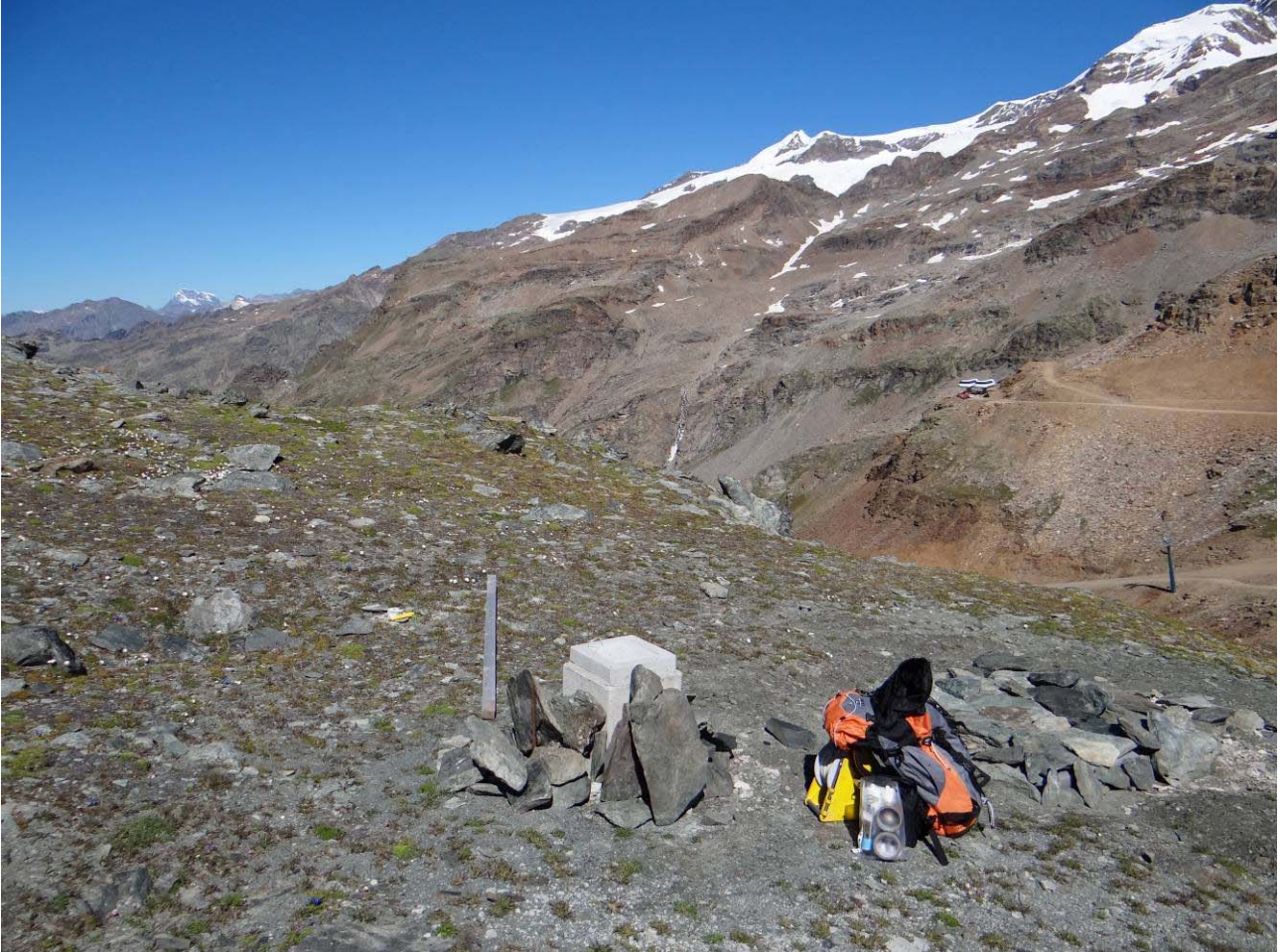
Sito del Passo dei Salati – Corno del Camoscio (Alagna Valsesia, VC) – Situazione della stazione al termine della fase di spurgo e di sopralzo testa-foro del pozzo effettuati nel 2010-2011 (foto: L. Paro, luglio 2012)
