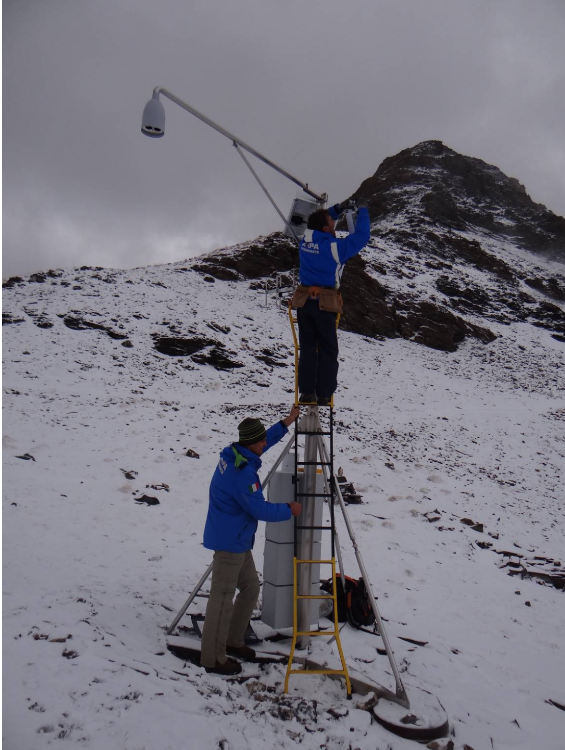
Sito de La Coletta (Bellino, CN) – Intervento di sostituzione del termometro aria della stazione meteorologica danneggiatosi nel corso dell'estate 2013 (foto: L. Paro, ottobre 2013)
