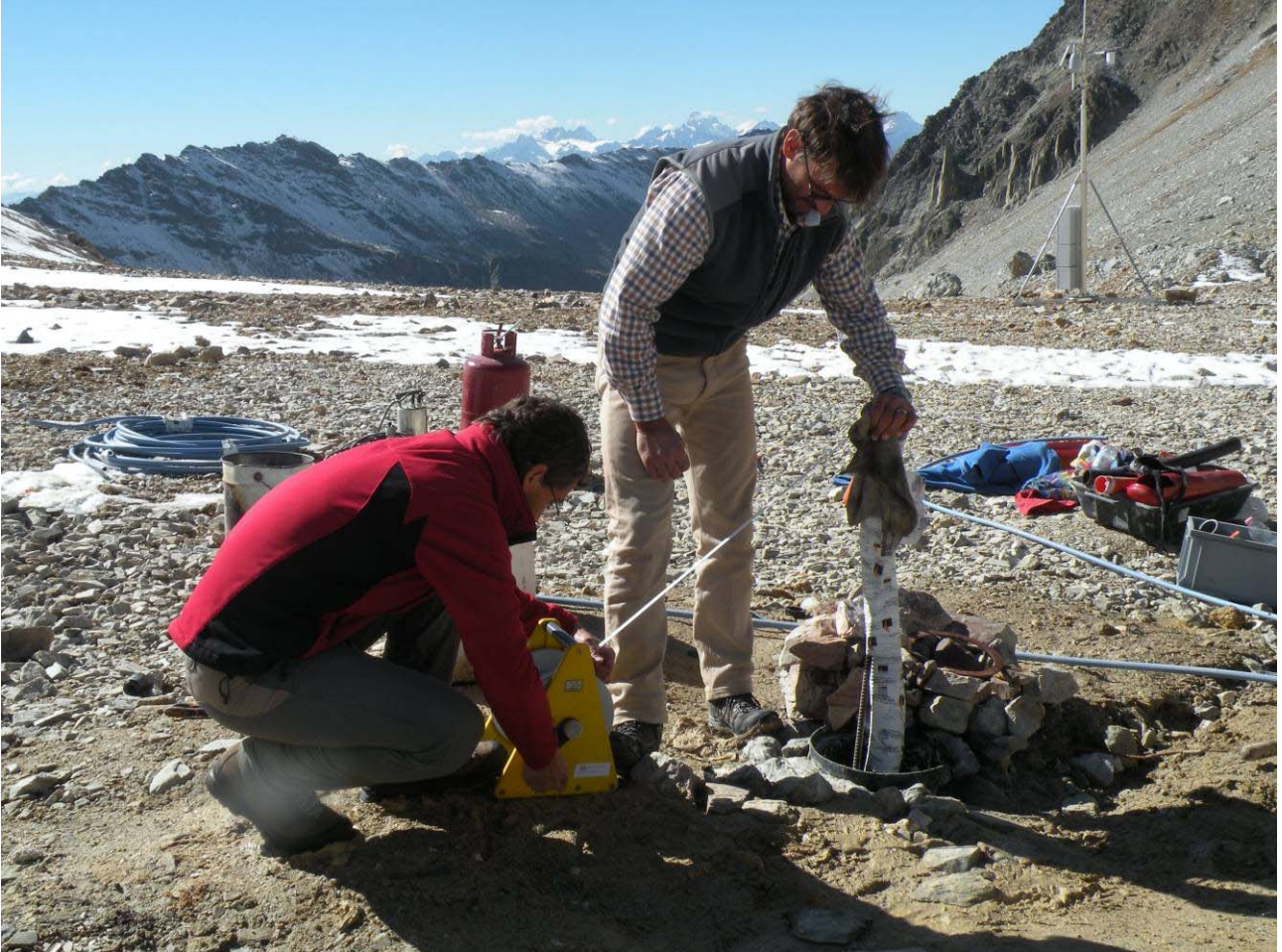
Sito del Colle Sommeiller (Bardonecchia, TO) – Verifica del livello dell'acqua nel pozzo profondo 100 m tramite freatimetro dopo una prima fase di spurgo (foto: D. Delleani, ottobre 2010)
