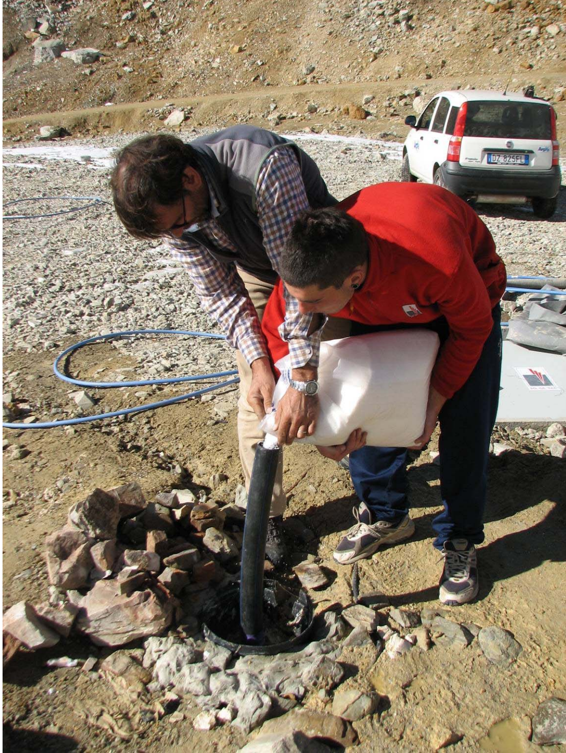
Sito del Colle Sommeiller (Bardonecchia, TO) – Inserimento di sale all'interno del pozzo per evitare il congelamento dell'acqua ancora presente all'interno (foto: D. Delleani, ottobre 2010)
