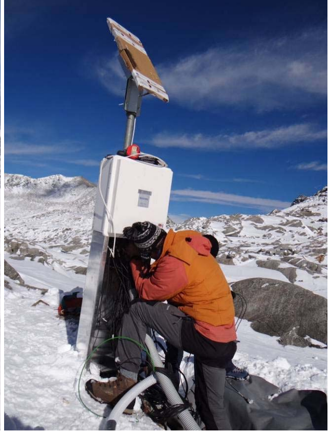
Sito del Passo del Monte Moro (Macugnaga, VB) – Sistemazione del palo di supporto sul quale vengono fissati il datalogger, il carter metallico di protezione dei cavi ed il pannello solare per l'alimentazione della stazione (foto: L. Paro, ottobre 2012)
