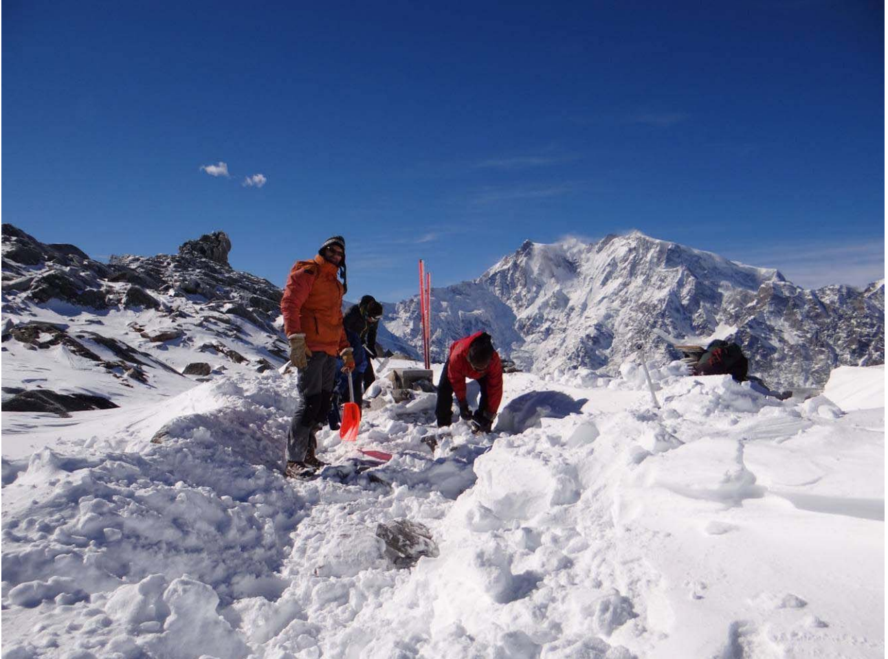
Sito del Passo del Monte Moro (Macugnaga, VB) – Inizio della seconda fase di ripristino della stazione di monitoraggio del permafrost; spalatura della neve caduta il giorno precedente alla ricerca degli strumenti e dei cavidotti da sistemare (foto: L. Paro, ottobre 2012)
