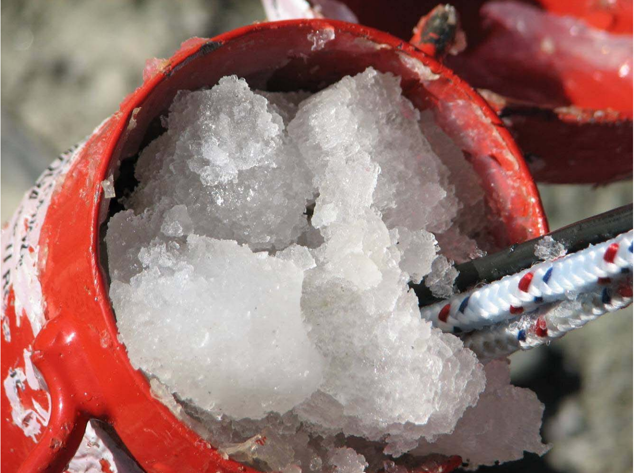
Sito del Passo dei Salati – Corno del Camoscio (Alagna Valsesia, VC) – Estrazione della catena termometrica dal pozzo profondo 30 m che evidenzia la presenza di ghiaccio all'interno (foto: L. Paro, settembre 2011)
