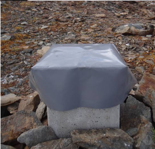
Sito del Passo dei Salati – Istituto Mosso (Alagna Valsesia, VC) – Inserimento del tubo di diametro inferiore all'interno del pozzo (dettaglio del fondo tubo tappato con termosaldatura). Completamento del tombino con cappuccio di protezione di plastica cerata (foto: L. Paro, settembre 2013).
