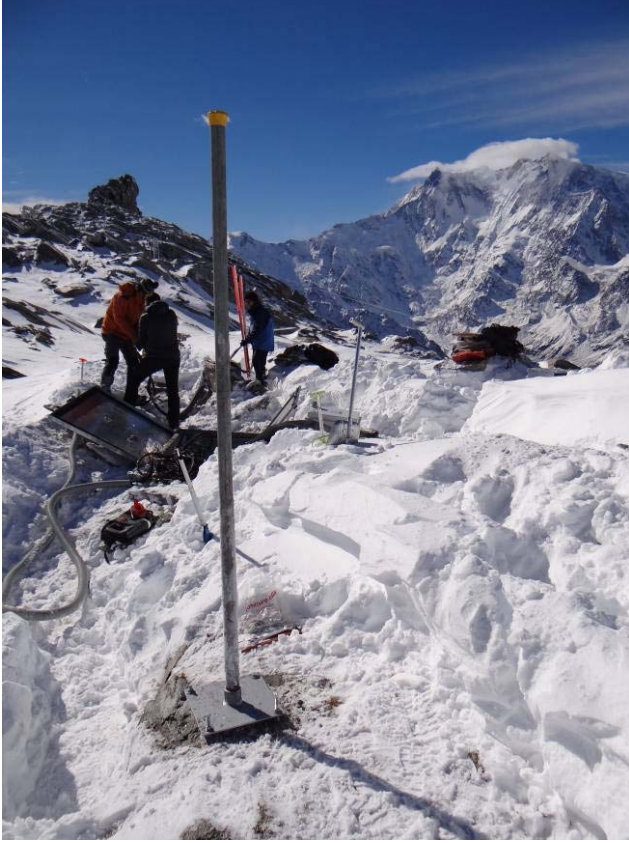
Sito del Passo del Monte Moro (Macugnaga, VB) – Sistemazione del palo di supporto sul quale vengono fissati il datalogger, il carter metallico di protezione dei cavi ed il pannello solare per l'alimentazione della stazione (foto: L. Paro, ottobre 2012)
