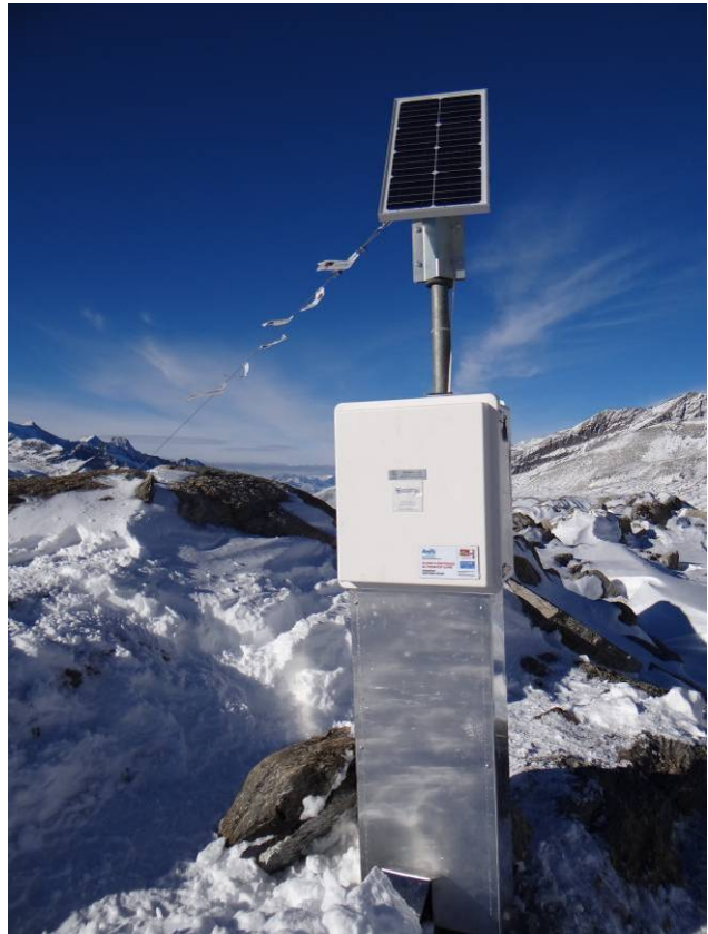
Sito del Passo del Monte Moro (Macugnaga, VB) – Sistemazione delle batterie tampone all'interno del tombino interrato e completamento del tombino della testa-foro del pozzo (a sinistra); completamento della stazione di monitoraggio con chiusura del carter metallico di protezione dei cavi e sistemazione del tirante (foto: L. Paro, ottobre 2012)
