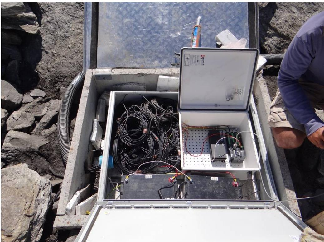
Sito del Passo del Monte Moro (Macugnaga, VB) – Fase di completamento della sopraelevazione della testa-foro del pozzo con messa in posto della protezione metallica e del tombino in cls (in alto) e sistemazione provvisoria del datalogger e delle batterie nel tombino adiacente (foto: L. Paro, luglio 2012)
