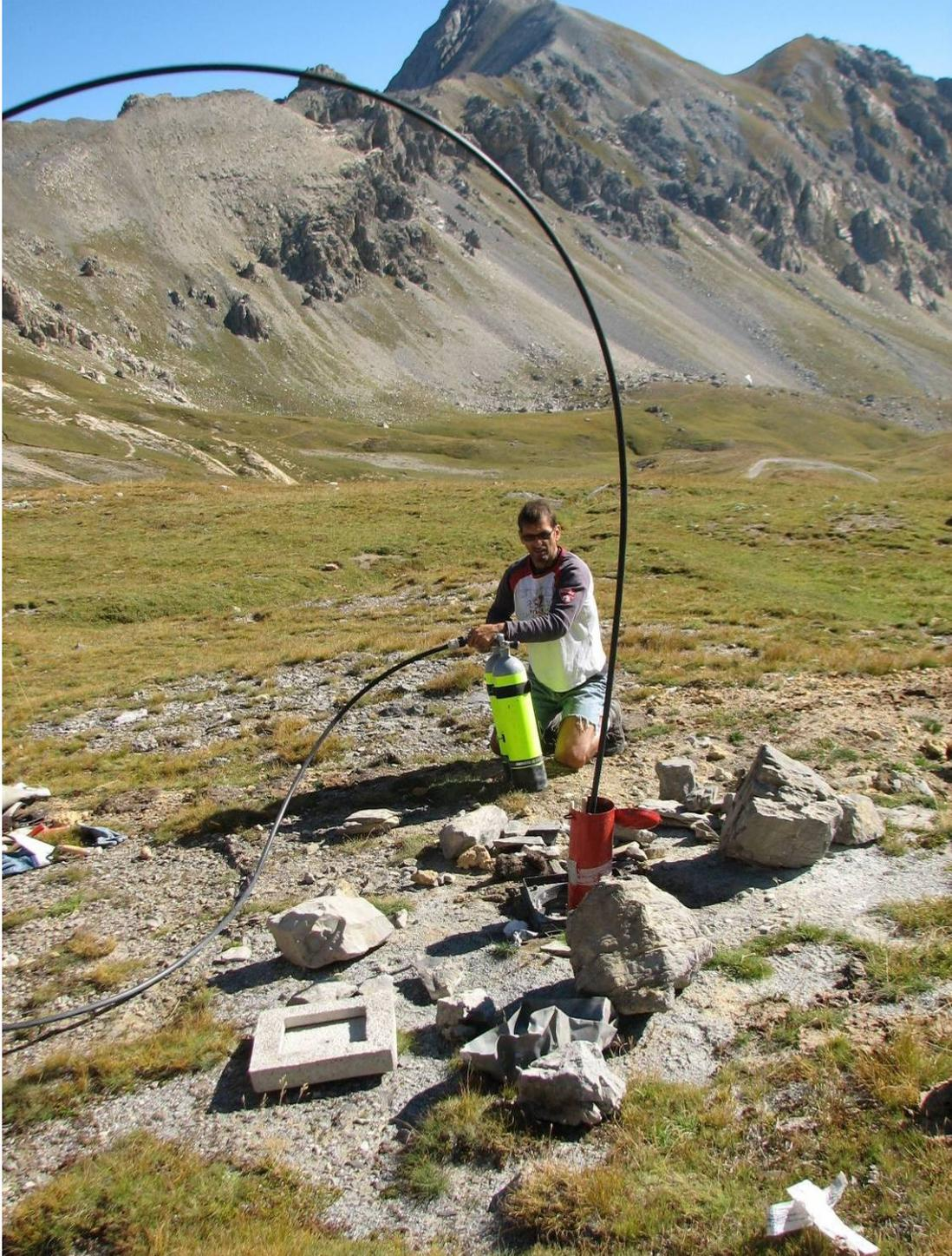
Sito del Passo della Gardetta (Canosio, CN) – Spurgo del pozzo profondo 30 m tramite estrazione dell'acqua con aria compressa (foto: L. Paro, settembre 2011)
