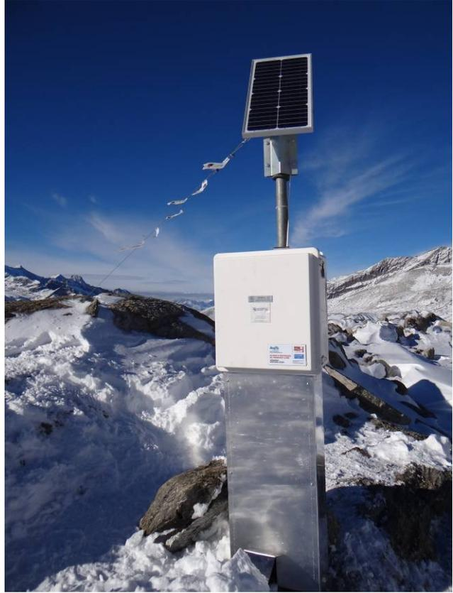
Sito del Passo del Monte Moro (Macugnaga, VB) – Sistemazione delle batterie tampone all'interno del tombino interrato e completamento del tombino della testa-foro del pozzo (a sinistra); completamento della stazione di monitoraggio con chiusura del carter metallico di protezione dei cavi e sistemazione del tirante (foto: L. Paro, ottobre 2012)
