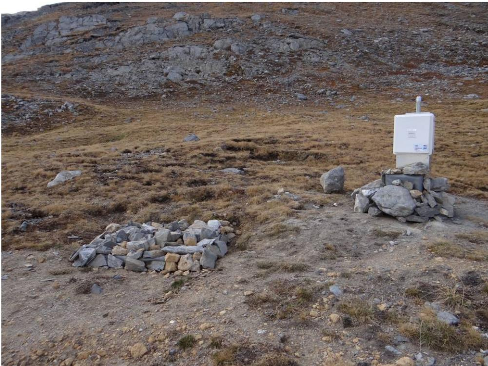
Sito del Passo della Gardetta (Canosio, CN) – Completamento della installazione (in alto) e risultato finale con datalogger su palo verticale e batterie di alimentazione posizionate nel tombino interrato (foto: in alto, G. Moletta, settembre 2012; in basso, L. Paro, ottobre 2012)
