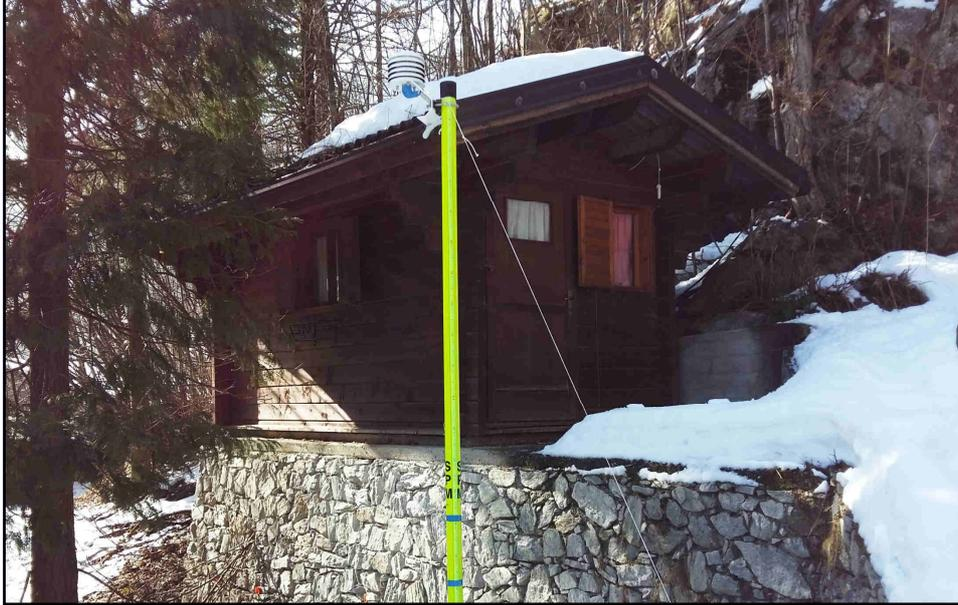
I sensori di temperatura ubicati a diverse altezze per misurare i valori termici dell'ammasso nevoso. Il palo porta-sensori è costituito da materiale non conduttivo
