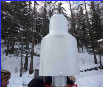
Pluviometro a pesata con liquido antigelo
