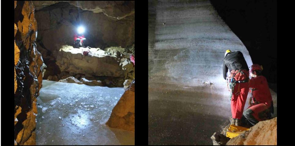
**Lo studio viene eseguito attraverso l'installazione nelle cavità ghiacciate di termometri per la misura in continuo della temperatura dell'aria e della roccia a differenti profondità (da 40 a 6 cm) e di campionamenti del ghiaccio e successive analisi chimiche**
