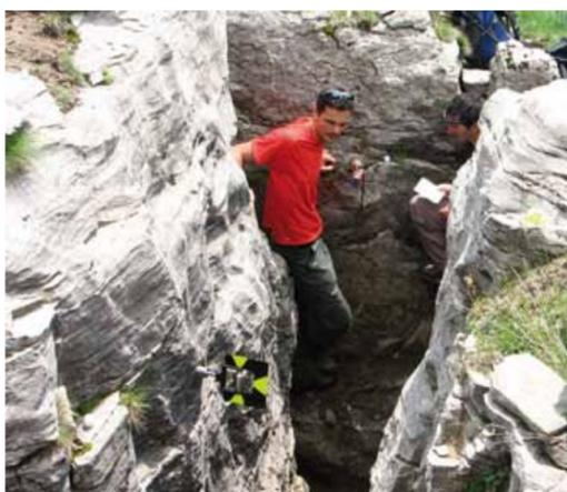
Le **basi distanziometriche** consistono in due supporti filettati, infissi alle pareti opposte di una frattura; la loro distanza viene misurata manualmente tramite un apposito strumento (distanziometro). Il confronto tra misure eseguite in epoche successive permette di determinare eventuali variazioni della distanza tra le pareti opposte della discontinuità posta sotto controllo.
