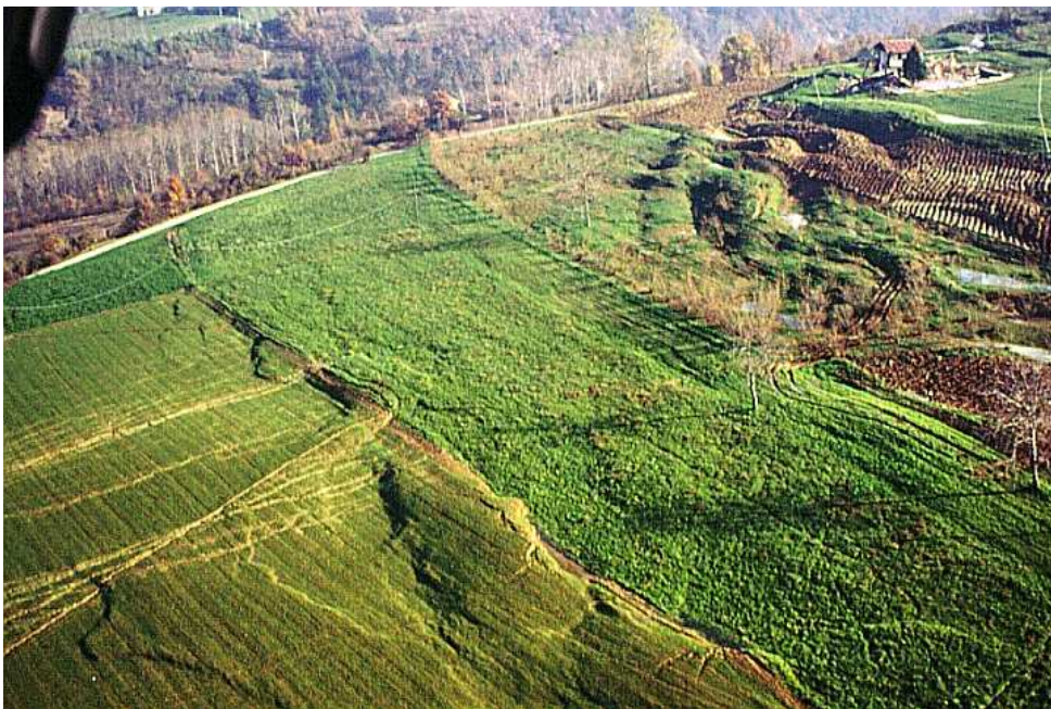
Immagine 03 - Piede della frana, i terreni sono vistosamente corrugati e fratturati
