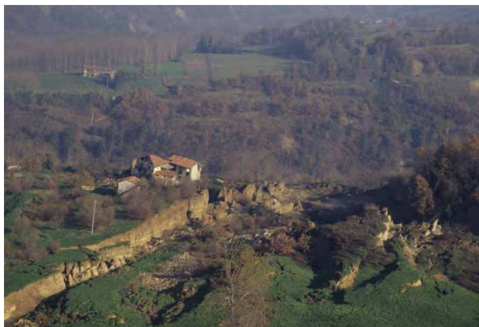
Immagine 06 - Panoramica della frana di Pianezza. A destra il coronamento. Le case sono traslate da destra verso sinistra di circa 50 m.
