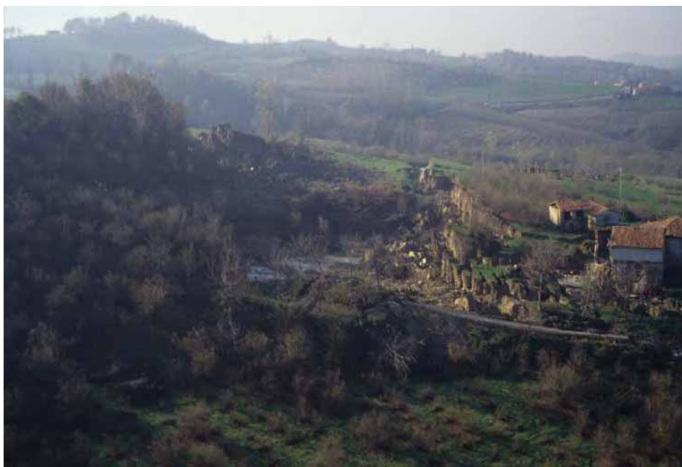
Immagine 05 - Panoramica della frana di Pianezza. A sinistra il coronamento. Le case sono traslate da sinistra verso destra di circa 50 m.
