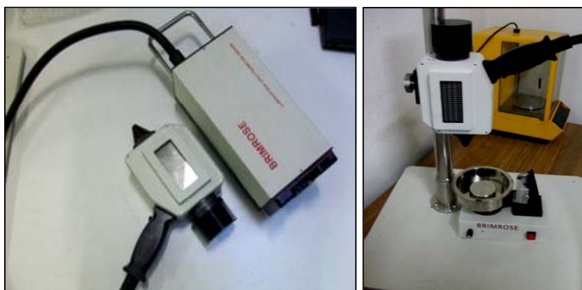
Figura 1. Sistema NIS-AOTF utilizzato per l'acquisizione dei dati spettrali NIR
