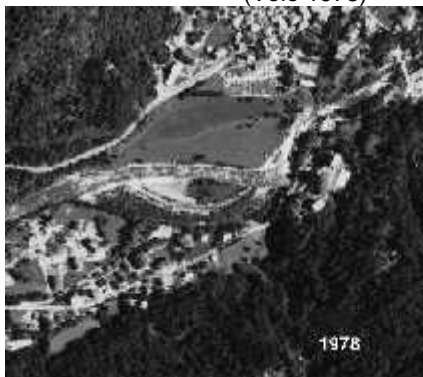
L'analisi aerotofogrammetrica multitemporale evidenzia l'importante erosione della sponda idr. sinistra e la variazione morfologica dell'alveo avvenuta in quella porzione di tratto.
