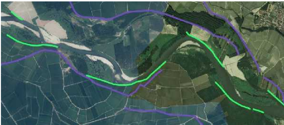
Attualmente il tratto è sinuoso a barre alternate ed è visibile solo un'ansa prima della traversa di Palestro ( Ortofoto 2012 ). In verde le difese spondali costruite dopo gli anni '70, mentre in viola gli argini già riconoscibili nelle fotoaeree del 1971.
