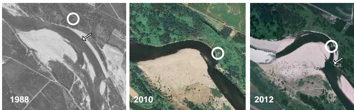
Erosione della sponda idr. sinistra nei pressi di c.na Valgrande. (Ortofoto 1988-89, 2010, 2012) Nell'immagine del 1988 si nota la difesa spondale, indicata dalla freccia, mentre nelle successive la forte erosione con aggiramento del traliccio dell'alta tensione (cerchio bianco) e della difesa stessa.
