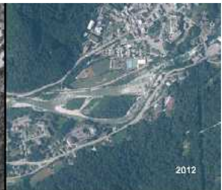
L'analisi aerotofogrammetrica multitemporale evidenzia l'importante erosione della sponda idr. sinistra e la variazione morfologica dell'alveo avvenuta in quella porzione di tratto.
